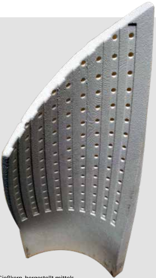
Gießkern, hergestellt mittels Binder Jetting . (Bild: WZR)
